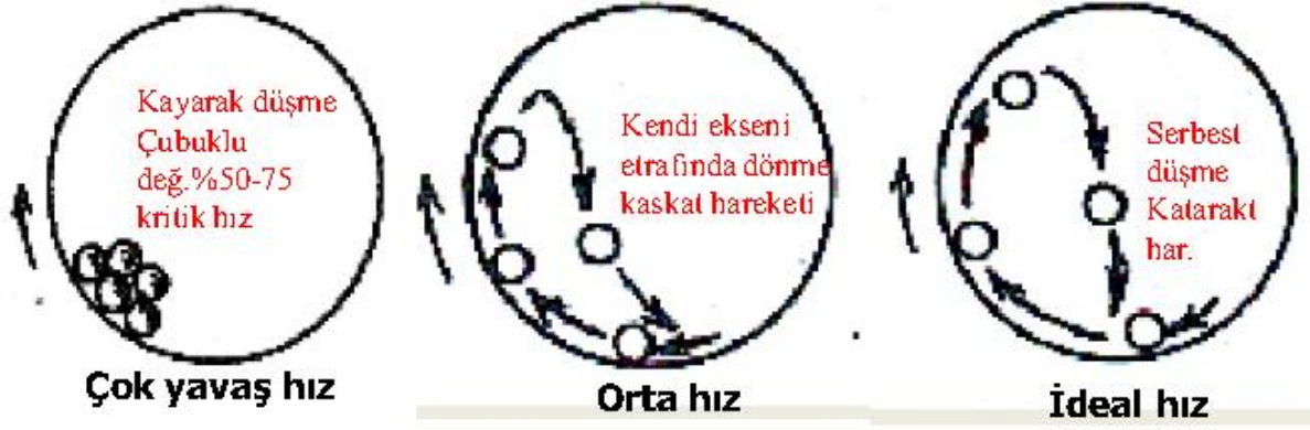
Şekil 3. Değirmen hızına göre bilya hareketinin şematik gösterimi.
